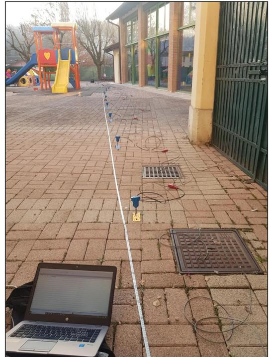
Il *sampling rate* utilizzato è stato di 512 Hz in modo da ottenere un elevato dettaglio del segnale. La durata (lunghezza temporale) del segnale registrato è stato di circa 6 minuti. Il software utilizzato per l'analisi spettrale è Grilla v.9.7 beta release 2021.
